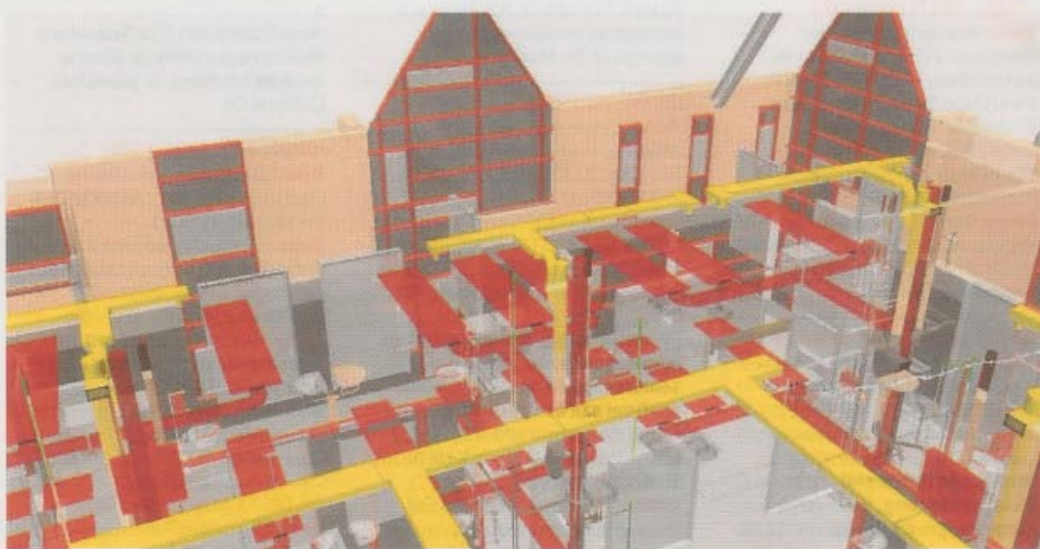
Model van zorgcentrum Mariënhof, met sanitair, leidingen en andere installaties.
